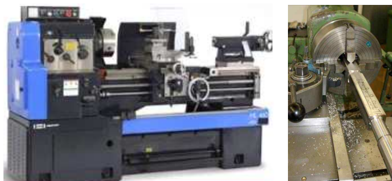
그림 6. 원형/사각 도체 원주 방향 절삭 장비
