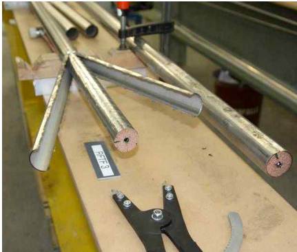
그림 1. Conduit Jacket 제거
