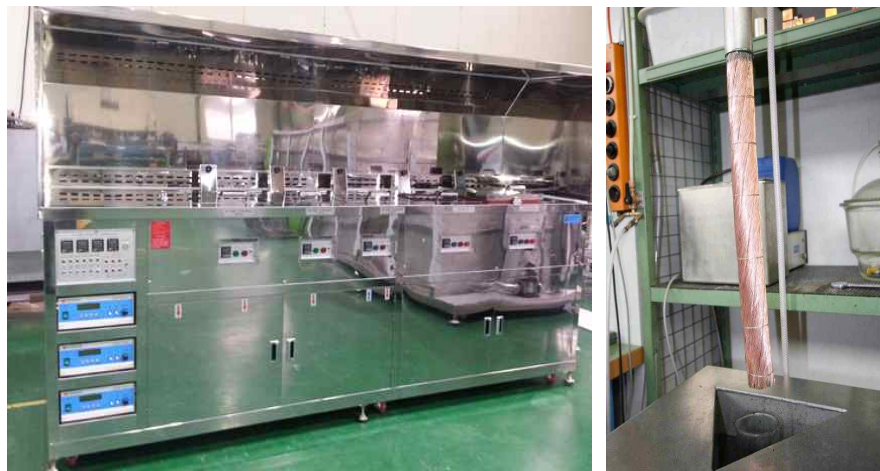
그림 7. 초전도 선재 표면 화학연마 장비
