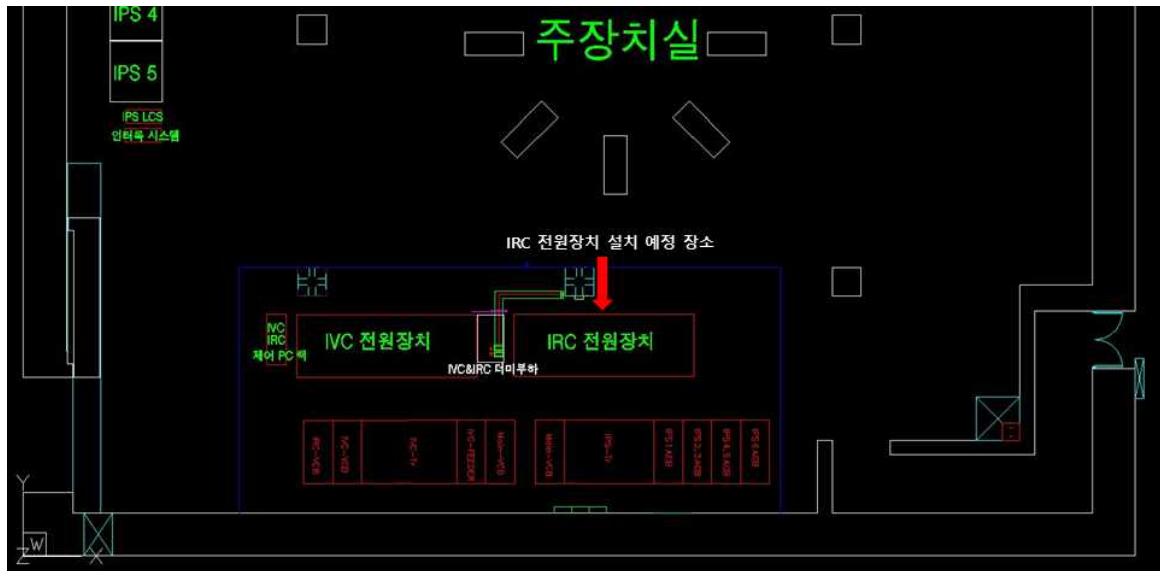
그림 3.2 IRC 전원장치 설치 위치(KSTAR 주장치실 D3층)
