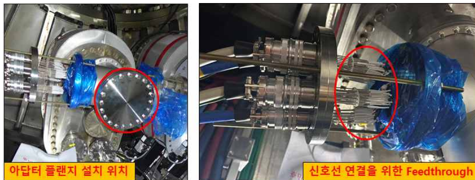
그림 4 수위 검출 센서 아답터 플랜지 및 신호선 연결 위치
