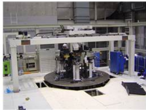
그림 5. KSTAR PF 권취턴테이블(Turntable) 형상
