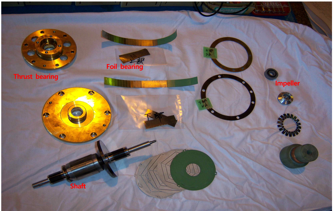
그림 3 초임계헬륨순환기 분해 사진
