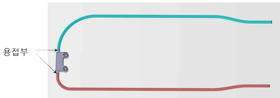
그림 3.3 ITER NAS 인보드 조사점 부분 전송선
