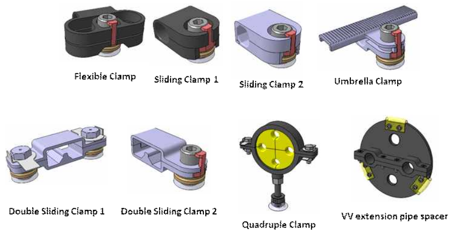
그림 3.4 ITER NAS IV 전송선 부품들 중 조사점과 클램프
