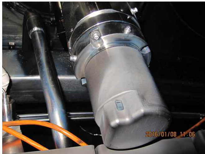
그림 6 N-port에 신규 설치될 FILD 헤드와 유사한 설계가 예상되는 FILD-2 헤드.
