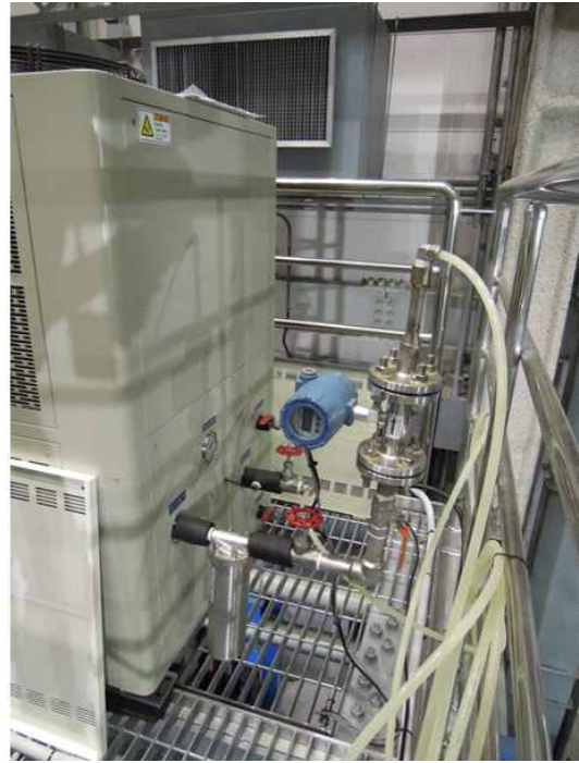
그림 16 마그넷 컴프레서 칠러 전, 후면 모습(후면의 배관을 4세트로 제작한다.)
