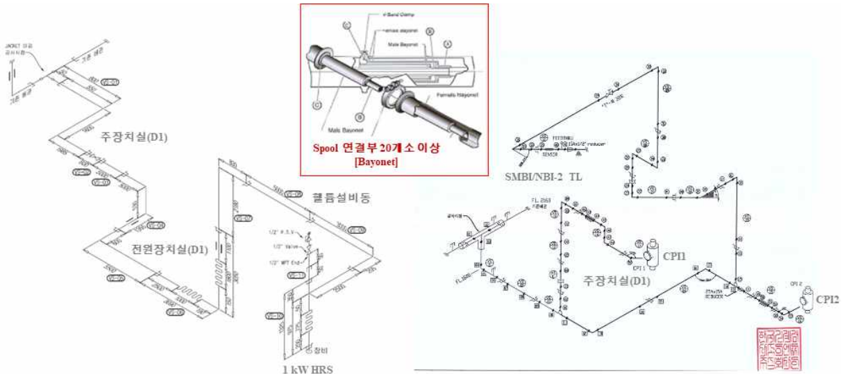
그림 9. 액체질소 전송관에 대한 Bayonet 연결부 위치 및 배관도
